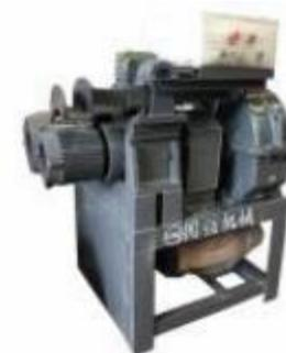
口圈碾丝机：用于废旧轮胎口圈碾丝、用电量每小时67.5°，价格：75000元
