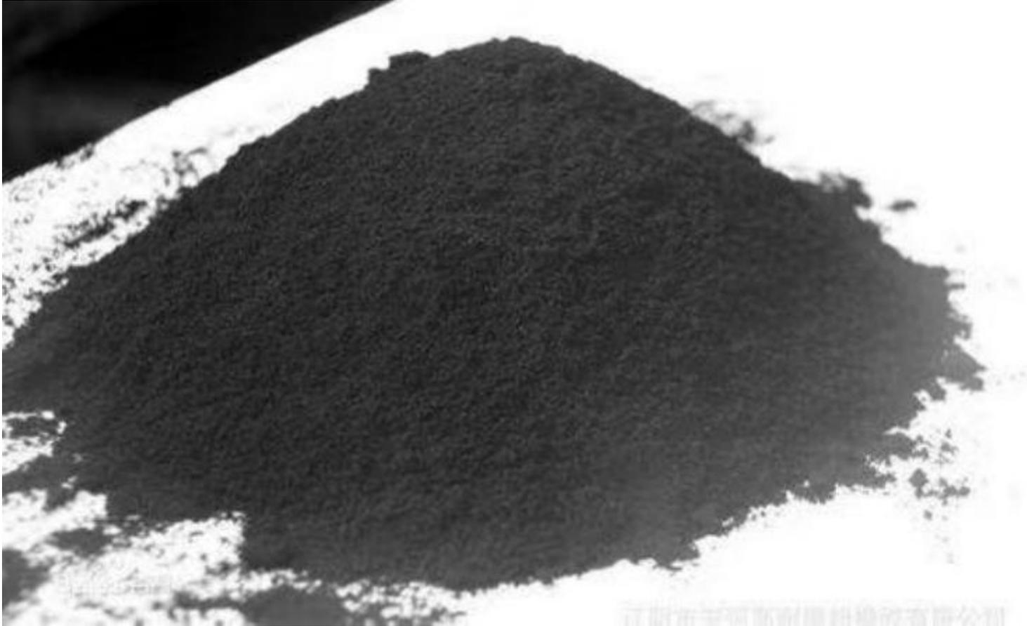
硫化橡胶粉：再生橡胶原材料
