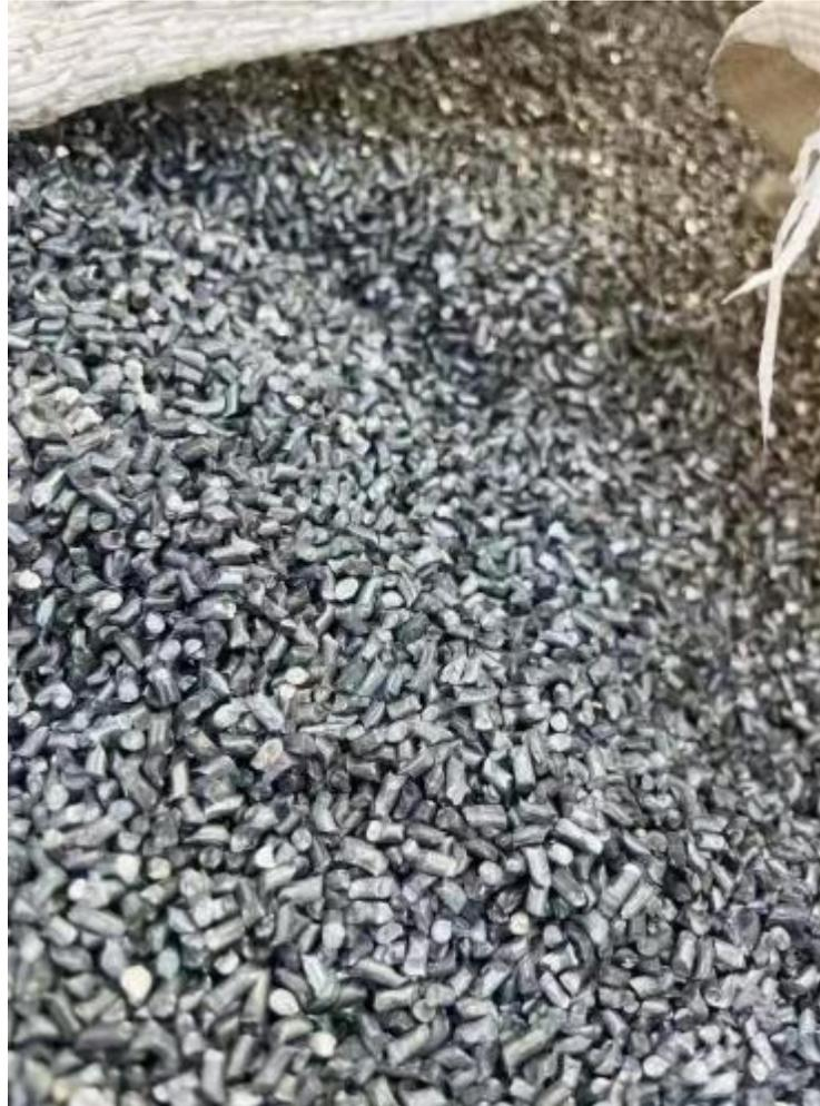
钢丝切丸：用于大型设备喷砂除锈
