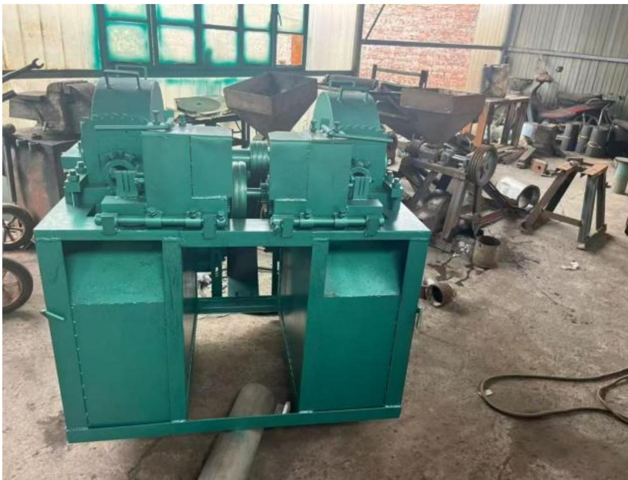
钢丝切丸机：轮胎口圈钢丝切成长度约3mm大小钢丝切丸，钢丝切丸用于大型设备研磨除锈，用电量为每小时52°，价格50000元
