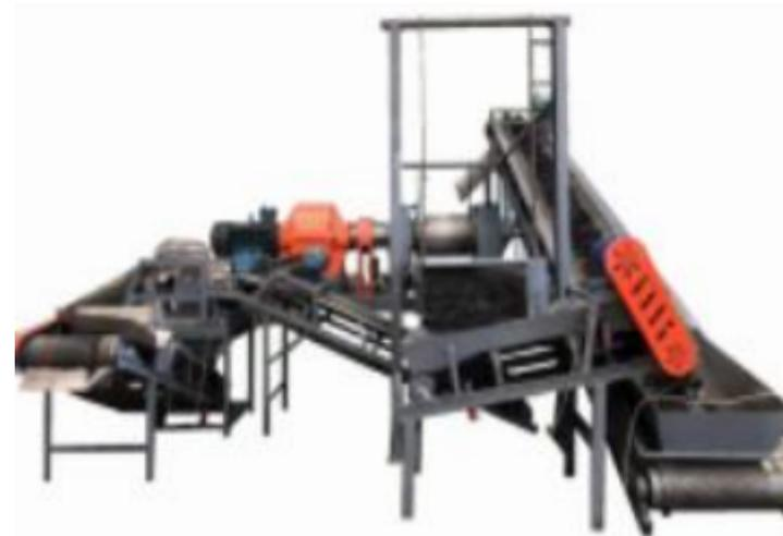
破胶机：轮胎毛丝分离，胶块研磨成粉，用电量为每小时428°，价格1100000元
