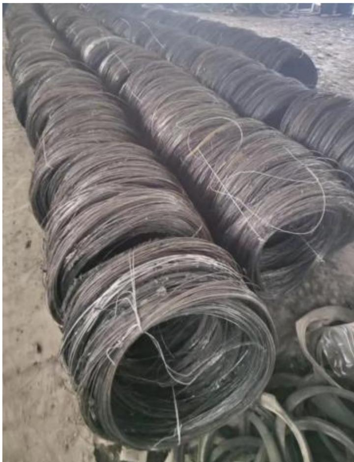
轮胎口圈钢丝：钢丝切丸基础材料
