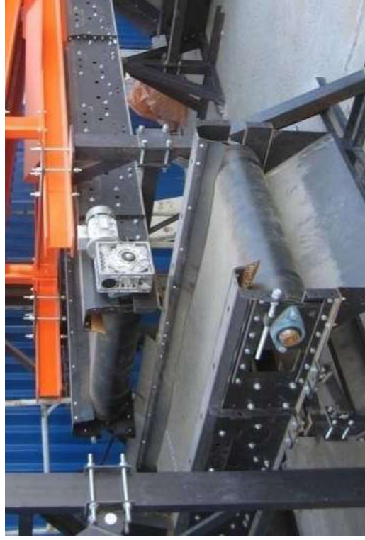
Ленточные конвейера: 6 моделей (Рабочая ширина, мм: 600, 800, 900, 1100, 1300, 1500)
